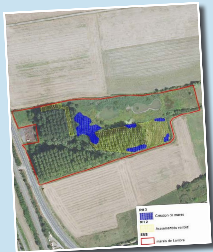
Plan des travaux de restauration
